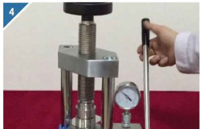
3、旋紧丝杠，将模具固定住。 4、上下摇动压机手柄，达到所需压力。
