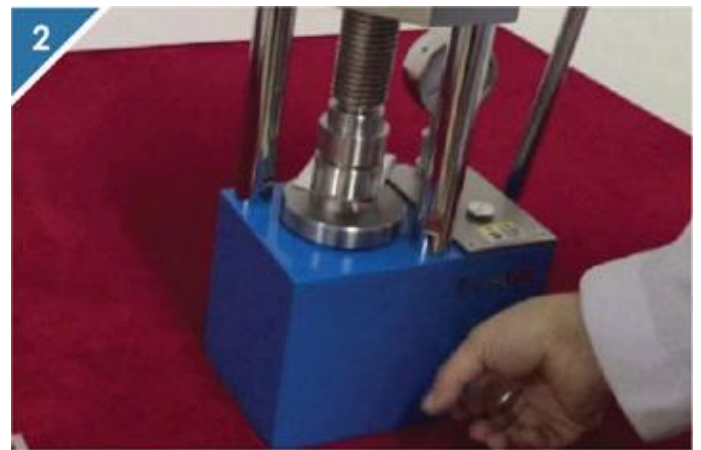
1、将组装好的模具放入压片机工作台中心位置。 2、顺时针拧紧压片机放油阀门。
