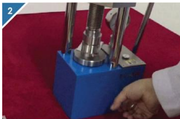
1、将组装好的模具放入压片机工作台中心位置。 2、顺时针拧紧压片机放油阀门。
