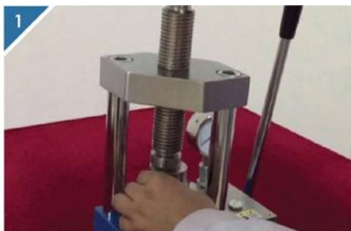
1、将组装好的模具放入压片机工作台中心位置。 2、顺时针拧紧压片机放油阀门。
