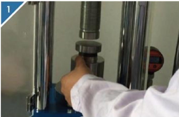
1、将组装好的模具放入压片机工作台中心位置。
