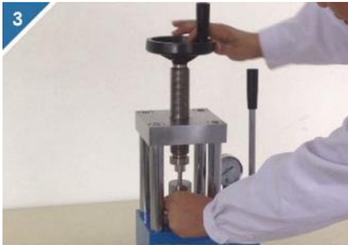
3、旋紧丝杠，将模具固定住。
