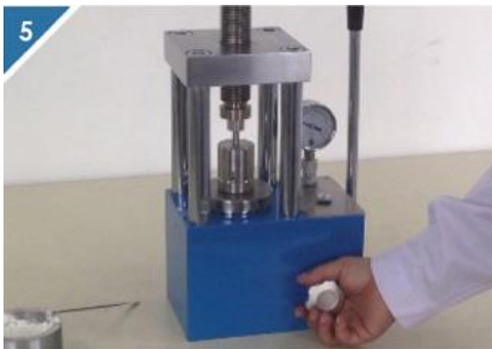
5、逆时针松开放油阀门，释放压力。
