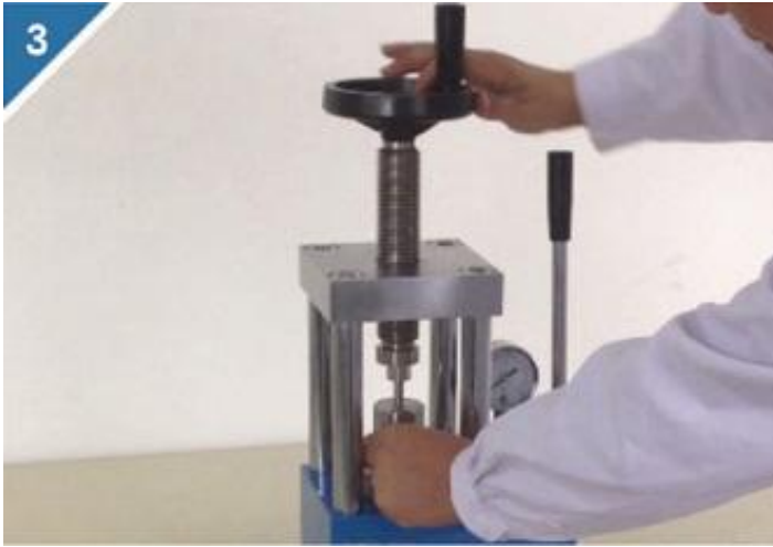
3、旋紧丝杠，将模具固定住。
